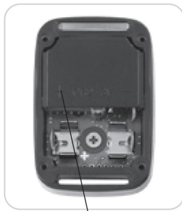
Markering van de polariteit van de batterij
