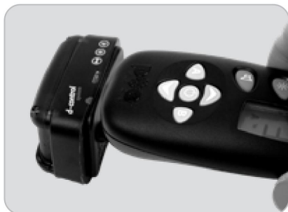
Positie bij het in-/uitschakelen van de ontvanger en bij het koppelen van de zender met de ontvanger
